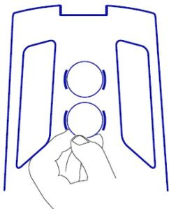
Entfernen Sie die Kieselgelkapsel, indem Sie sie von hinten anheben.
