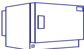
Regenerieren Sie das Kieselgel durch Trocknen in einem Laborofen bei 60 - 65°C 24 Stunden lang, bis es gelb aussieht.
