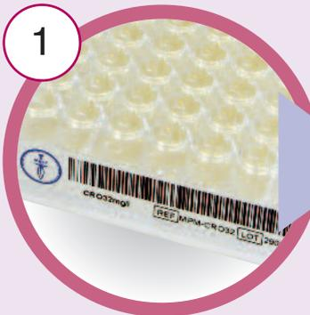
1 Mast Uri® Plate est scanné puis placé sur le palteau tournant du Mast Uri® Plus
