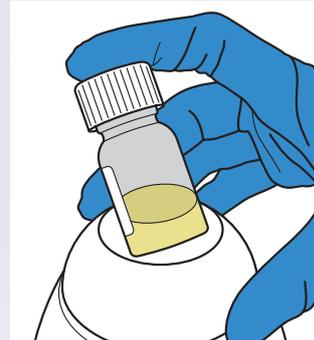
Pellet 1 Minute bei Raumtemperatur lösen und für 10 Sekunden vortexen.
